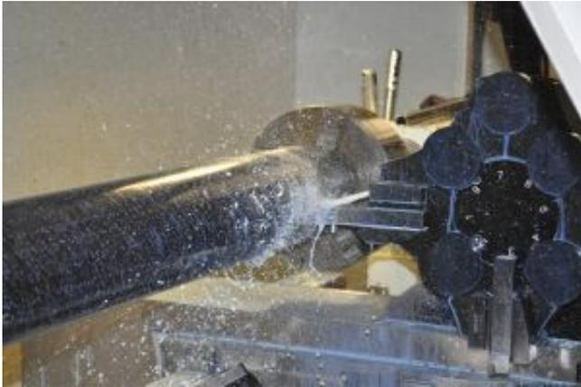
Wir drehen für Sie Wellen und Achsen bis zu 4 Meter Länge und Durchmesser 390 mm über dem Querschlitten.
